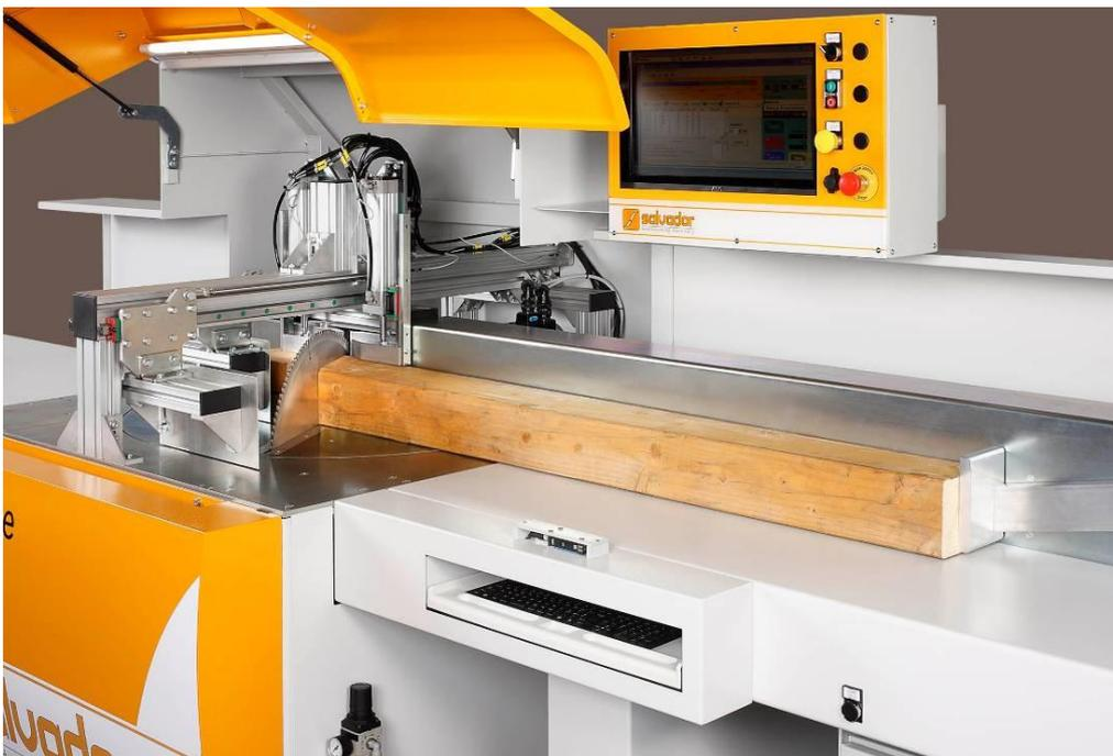
Der Schiebervorschub wird vom Computer und von der numerischen Steuerung gesteuert
