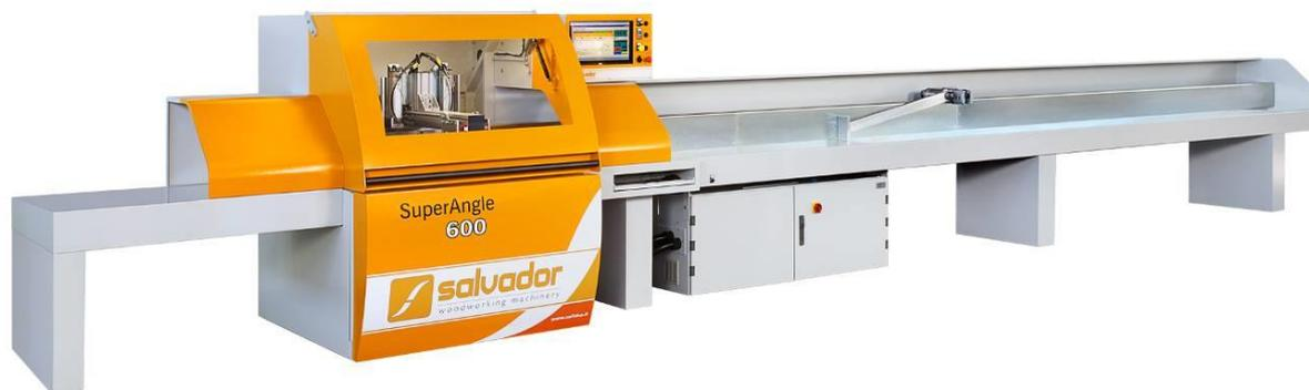
Die Superangle 600 is die ideale Säge für winkeloptimiertes Sägen. Als Weiterentwicklung klasischer Sägesysteme, steigert sie die Produktivität bei maximaler Präzision.
