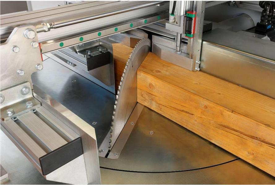
Es handelt sich dabei um eine sehr dicke und stabile Blech- und Stahlrohrstruktur.
