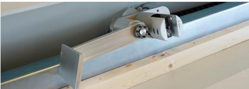
ist ein integriertes Einlesesystem, das aus einer Laser-Fotozelle zur Holzerfassung und aus einem speziellen Fluoreszenzsensor zur Zeichenablesung besteht.
