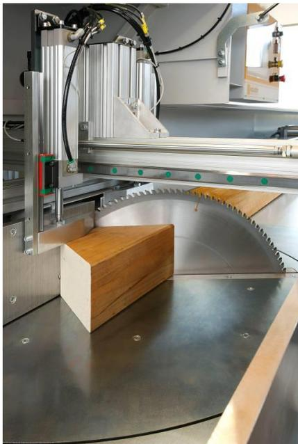
Drehtisch mit Präzisionslagerrad mit Durchmesser 550 mm, Rotation durch bürstenlosen Motor **mit spezieller Pause während des Schnitts.**
