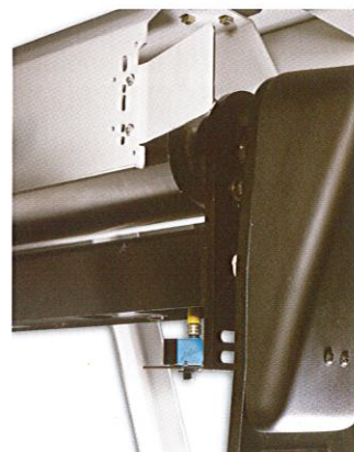
○ electronic belt tracking centrage électronique des bandes Elektronische Bandzentrierung
