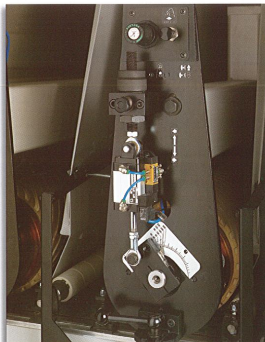
electro-pneumatic exclusion unit exclusion électro-pneumatique du groupe pneumatische EIN/AUS Aggregate
