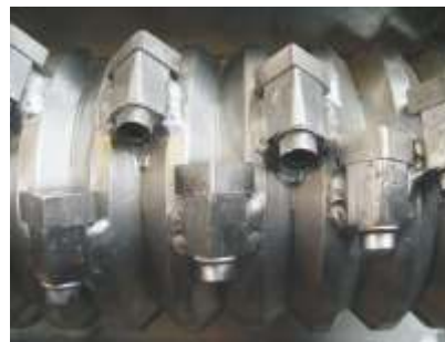
Profilrotor mit geschweißten Messerträgern (GAZ 62 S)
