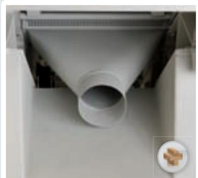
Absaugstutzen im Maschinenständer integriert.
