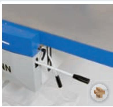
*Bedienhebel für die manuelle Span-tiefenverstellung und für die Hohl-/Spitzfugeneinstellung.*
