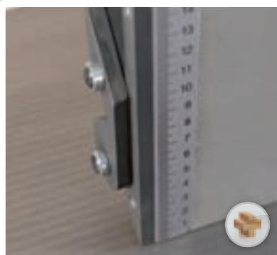
Praktisch: die zusätzliche Skala am Abrichtanschlag.
