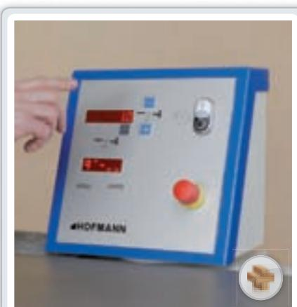
*Elektrische Spantiefenverstellung über Taster mit LED-Anzeige. Betriebsstundenzähler inklusive.*
