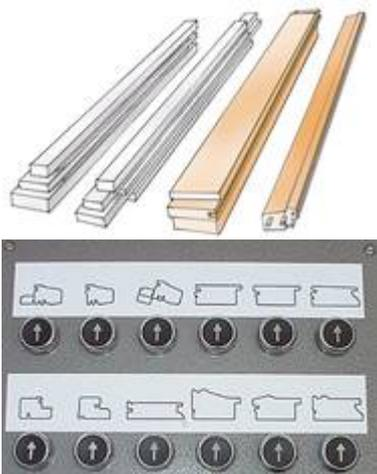
Beispiel: Profilvorwahl einfach per Taster mit automatischer Einstellung aller schleifrelevanten Parameter in Sekundenschnelle
