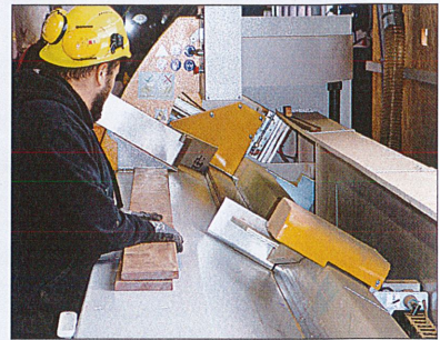
Die für 6,2 m lange Werkstücke ausgelegte Auflagefläche ist im Winkel von 30° schräg angeordnet. So können ganz ohne mechanische Hilfe, einfach der Schwerkraft folgend, mehrere Dielen parallel aufgelegt werden, die dann nachrutschen, wenn der automatische Schieberschlitten die erste Dielen mitgenommen hat.
