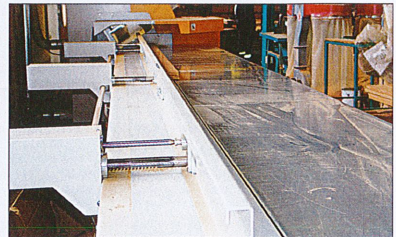
Klapptisch am Auslauf der mit der Dielen in die Horizontale kippt. Mit Schiebern wird das Werkstück hydraulisch abgelegt.
