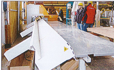
Klapptisch am Auslauf der mit der Dielen in die Horizontale kippt. Mit Schiebern wird das Werkstück hydraulisch abgelegt.
