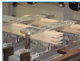
Sämtliche gängigen Eckverbindungen wie Zapf-Schlitz, Konter-Dübel, Konter-Schraube und neue Eckverbindung „gestemmter Zapfen“ möglich!
