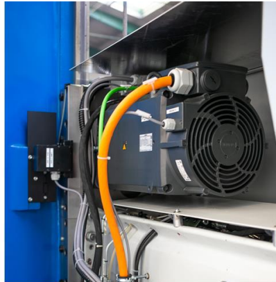
Siemens spindle motor 18.5 kW
